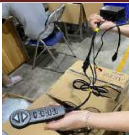
Thành phẩm bộ điều khiển gồm hộp mạch và công tắc điều khiển
